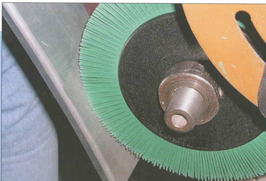
Обработка поверхности радиальной щеткой Scotch-Brite™ Bristle 200 мм, тип S
